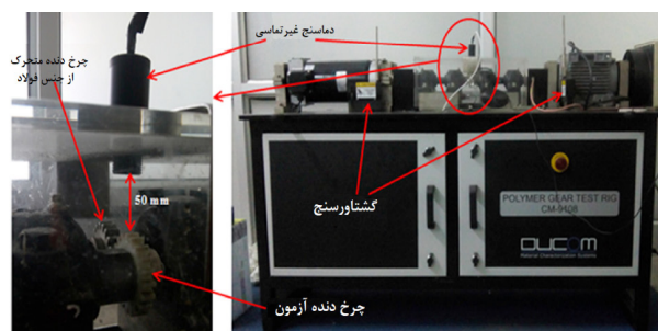
شکل ۴ دستگاه آزمون چرخ‌دنده و بکارگیری دماسنج غیر تماسی مادون قرمز برای اندازه‌گیری دمای کاری چرخ‌دنده‌ها [۱۱].
