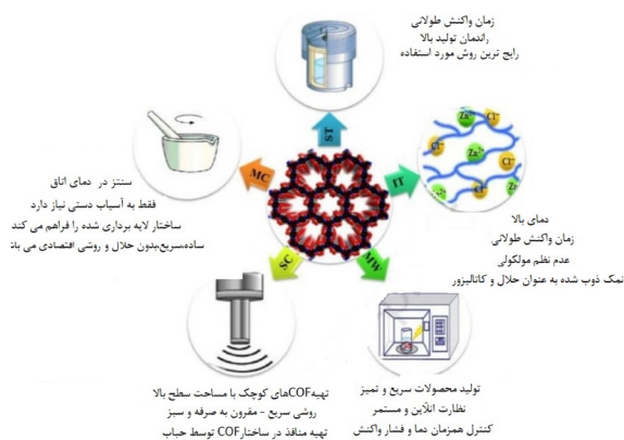
شکل ۱ طرح‌واره خواص و مزایای روش‌های مختلف COF ها (MC و ST، IT، MW، SC) برای ساخت COF ها.
