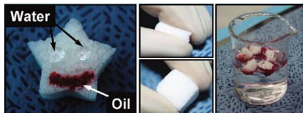
شکل ۶ آب‌گریزی اسفنج PDMS در تماس با مخلوط آب و نفت [۱۹].
