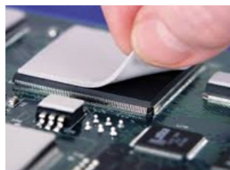
شکل ۱ کاربرد لاستیک سیلیکون در صنعت الکترونیک. صفحات انعطاف‌پذیر رسانای گرما [۱۹].
