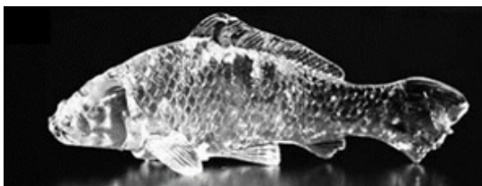
شکل ۵ هیدروژل DN-PVA تهیه شده با روش شکل‌پذیری آزاد [۱۵].
