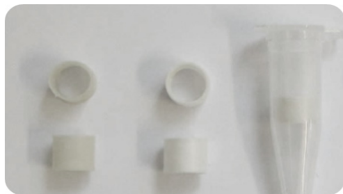
شکل ۸ جاذب چاپ شده توسط چاپگر سه بعدی با روش روزن رانی مواد [۱۷].
