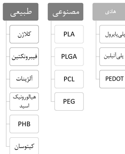
شکل ۳ برخی از انواع پلیمرهای مورد استفاده در مهندسی بافت عصب [۱۲]
