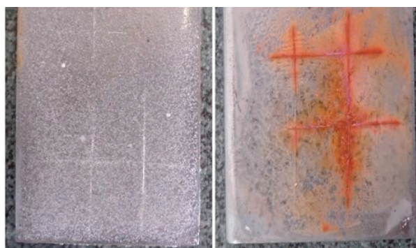
شکل ۶ (الف) صفحه فلزی با پوشش اپوکسی فاقد میکروکپسول و ایجاد محصولات ناشی از خوردگی (ب) صفحه فلزی با پوشش اپوکسی حاوی میکروکپسول بدون زنگ‌زدگی. نمونه‌ها به مدت ۴۸ ساعت در معرض محلول ۱۰ درصد آب-نمک قرار گرفتند [۲۰]
