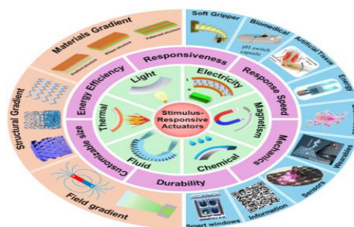
شکل ۲ طرح واره ی کلی از عملگرهای نرم پاسخگو به محرک های محیطی و کاربردهای آن در حوزه های گوناگون [۱۴].
