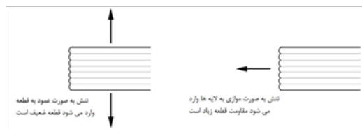
شکل ۵ مقایسه مقاومت به تنش در جهت Y و X با جهت Z
