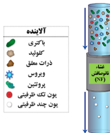
شکل ۱ اساس روش حذف آلاینده‌ها از پساب با استفاده از غشای نانوصافش (NF).
