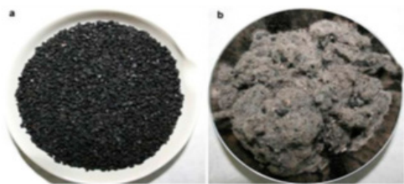
شکل ۷ تصاویر نمونه‌ای از ذرات لاستیکی خرد شده (۱۰-۱ میلی متر) (a) و الیاف تقویت‌کننده (b) [۱۲].
