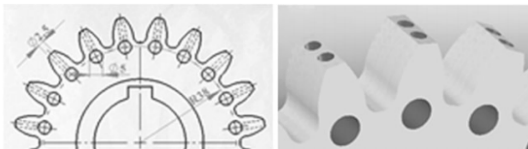
شکل ۵ مدل دوم سوراخ کاری برای افزایش خنک کاری در دنده چرخ دنده از دو نمای متفاوت [۱۰].
