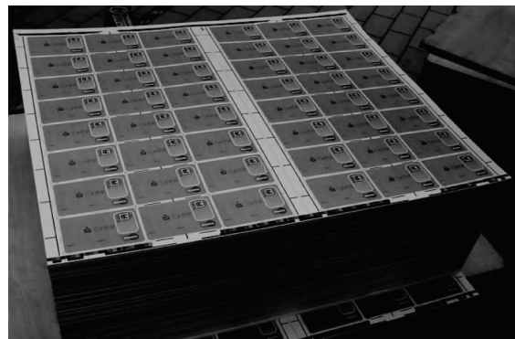
شکل ۱۱ ورقه‌های بزرگ پلاستیک هر یک حاوی ۴۸ تصویر از کارت [۲].
