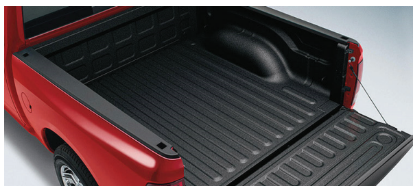
شکل ۱۱ پوشش پلی‌اوره‌ای بر روی ماشین باری
