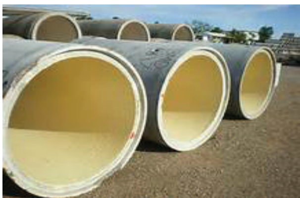
شکل ۹ مخازن پوشش داده شده با پلی‌اوره
