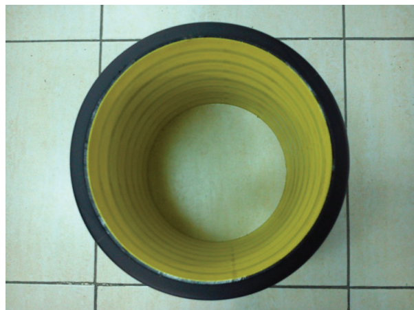
ب- نمونه پس از گذشت ۲۴ ساعت از انجام آزمون شکل ۵ نمونه آزمون انعطاف‌پذیری حلقوی [مولف].
