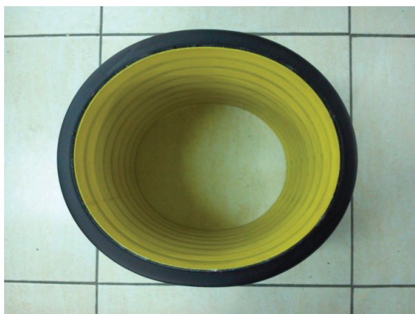
الف- نمونه خارج شده از زیر بار بلافاصله پس از آزمون
