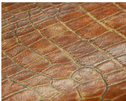
شکل ۱۳ پلی یورتان پایه آبی / آکریلات برای روکش نهایی چرم [۲۸]
