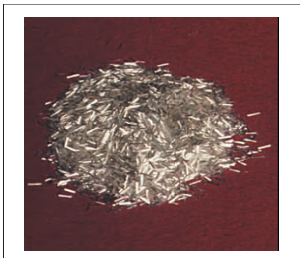
شکل ۱ بریده‌های الیاف شیشه به همراه آمینوسیلان به عنوان عامل تقویت‌کننده گرمانرمها [۱۶]
