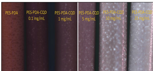
شکل ۴ میکروسکوپ فلورسانس سطوح زیرلایه غشاهای PES-PDA و PES-PDA-CQD تحت تحریک نور UV به عنوان تابعی از غلظت CQD (۱، ۵، ۱۰ و ۲۵ میلی گرم بر میلی لیتر) در محلول های پوششی [۳۷].
