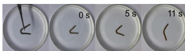
شکل ۱۲ رفتار حافظه شکلی هیدروژل \alpha -Go/P(AM-CO-PEGMA) با پاسخگویی به گرما [۱۳].
