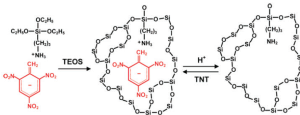
شکل ۸ طرحواره سازوکار قالب‌گیری مولکولی برای مولکول TNT در ماتریس سیلیکا از طریق جفت کردن آنیون-کاتیون و واکنش انعقاد [۵۱]
